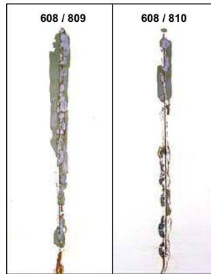
500 Hour Salt Fog: 2.2 mil DFT on B1000
